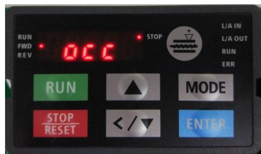
KPVJ-LE02 數位操作面板顯示之異常訊息，左圖為數字碼顯示方式，右圖為數字碼所對應的英文顯示碼顯示方式。兩者會自動切換顯示。
