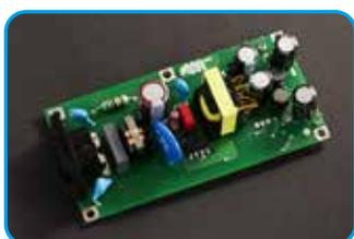
工業電源電路板
