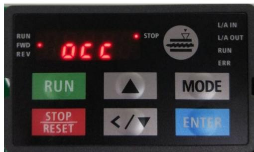
KPVJ-LE02 数字操作面板显示之异常讯息，左图为数字码显示方式，右图为数字码所对应的英文显示码显示方式。两者会自动切换显示。
