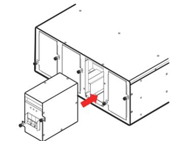
**注：**若安装两个 30A 或 32A 的断路器模块 (选配)，必须每隔一个插槽安装断路器模块，并确保插槽盖板有覆盖，请参阅下图。
